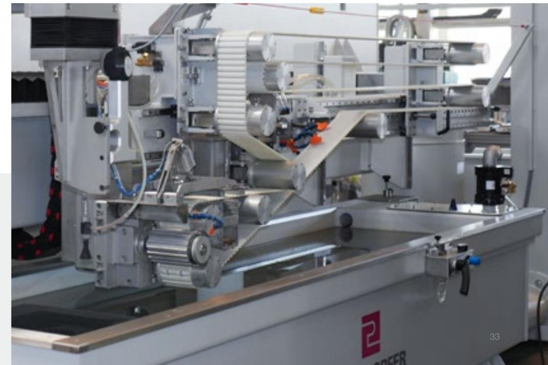
Vorrichtung zum Bearbeiten von Zahnriemen im Detail
