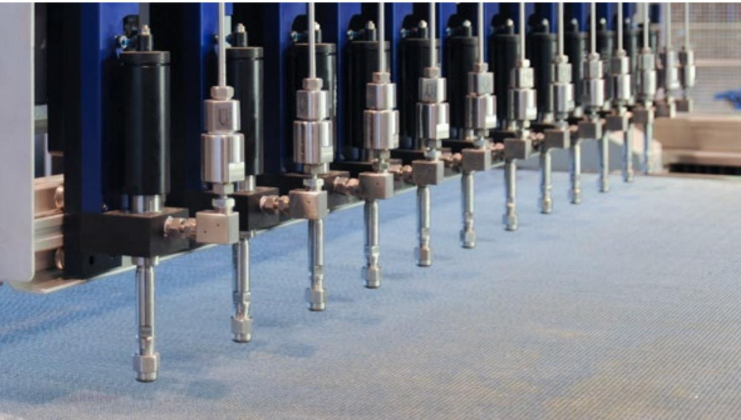
Sie suchen ein Trennverfahren ohne thermische Einflüsse, bei dem das Material nicht verbrennt, Mikrorisse bekommt, aufhärtet oder sein Gefüge verändert? Dann ist Wasserstrahlschneiden womöglich das Richtige für Sie
