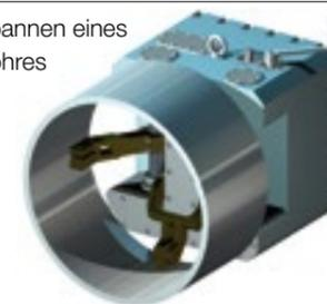
Spannen eines Formrohres
