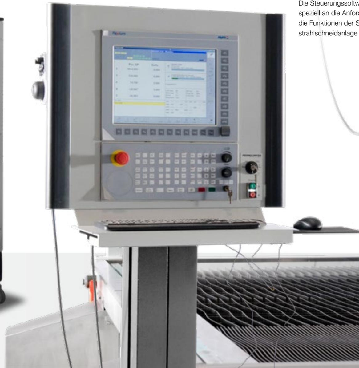
Die Steuerungssoftware wird speziell an die Anforderungen und die Funktionen der Sonder-Wasserstrahlchneidanlage angepasst.
